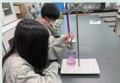
溶存酸素要求量の計測実験
