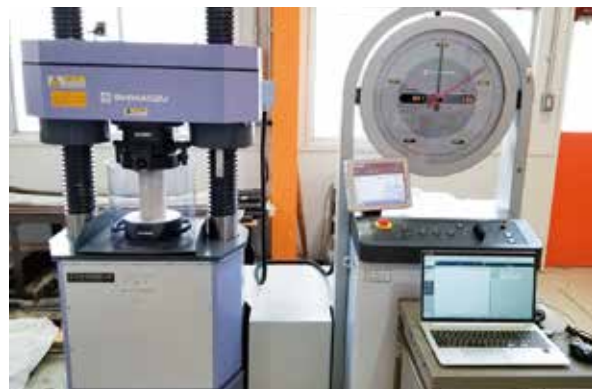
2000kN圧縮試験機による強度実験 Strength test with 2000kN compression testing machine
