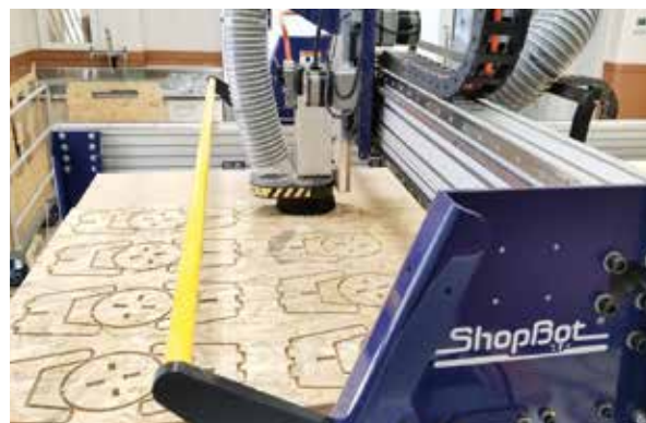
CNCルーターによる木材加工 Wood processing with a CNC router
