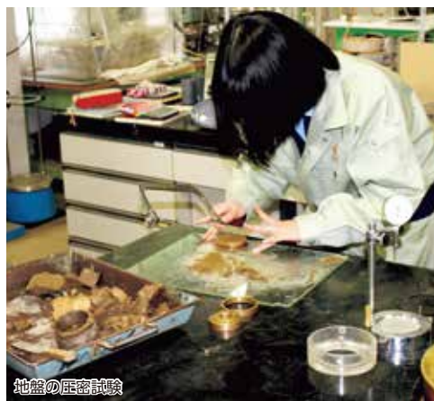
地盤の圧密試験
