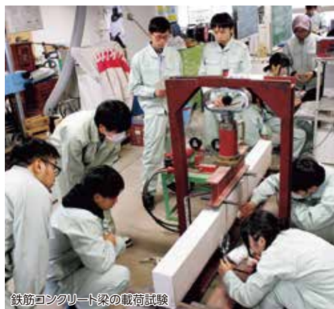
鉄筋コンクリート梁の載荷試験
