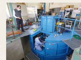
動的遠心力模型実験装置
