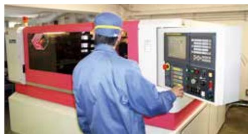
炭酸ガスレーザー加工機
