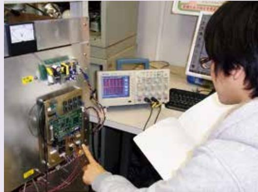
ACサーボモータの制御実験
